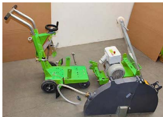
Przecinarka po rozłożeniu na 3 podzespoły
